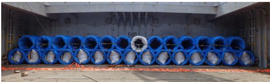
【多段積み線材コイル羽口の一段目に積載された線材コイル内周部にエアバッグを使用】
