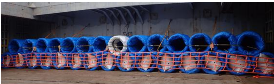
【多段積み線材コイル羽口の一段目に積載された線材コイルにネットを展張】
